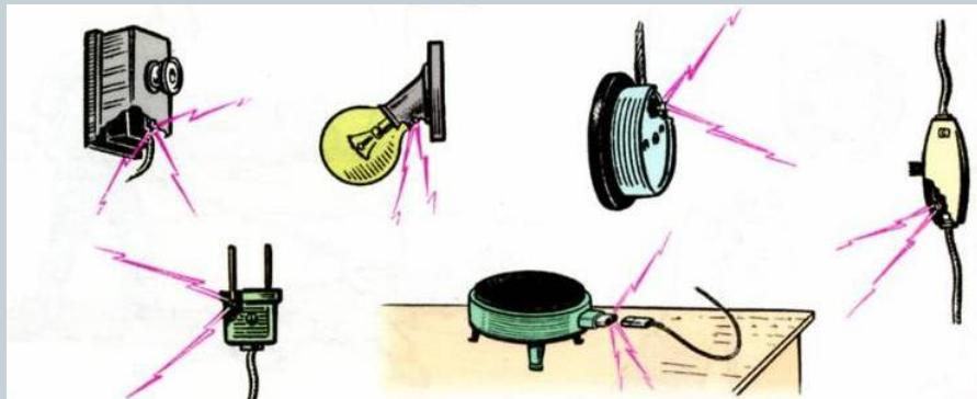
Использование электроприборов с поврежденной изоляцией проводов может привести к смертельному поражению током.
